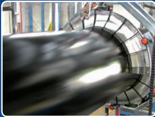
Prüfung von PE / PP- und FBE- Beschichtungen bis zu DN 1600
